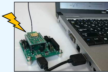
専用マザーボードWCU-CXARMを通してPCに接続
